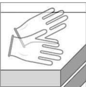
Во время работы с бетонными панелями необходимо использовать чистые защитные перчатки и строго соблюдать технику безопасности. Так же следует избегать попадания на поверхность панелей жировых и масляных загрязнений.
