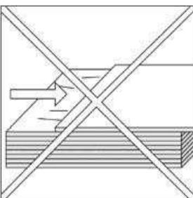
Для перемещения и монтажа бетонных панелей следует использовать соответствующее оборудование или выполнять разгрузочные работы вручную. Категорически запрещается двигать одну панель по поверхности другой, когда они сложены в стопку на паллете.
