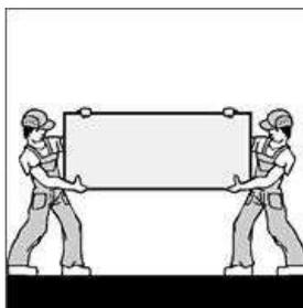
Во время перемещения и монтажа бетонных панелей следует избегать прогибов и вибраций. Бетонные панели надлежит переносить строго в вертикальном положении. При этом перемещение панелей с размерами 600x600, 750x500 и 800x800 мм, можно выполняться одним работником. Бетонные панели больших размеров следует перемещать строго двумя работниками.
